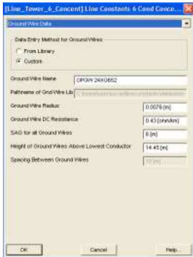
Fig. 9. 24xG652 OPGW conductor data
